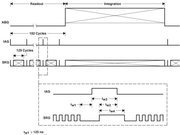
$\begin{array}{l} t_{W1} \geq 125 \text{ ns} \\ 50 \text{ ns} \leq t2 \leq 250 \text{ ns} \\ t_{W3} \geq 600 \text{ ns} \\ t_{W4} \geq 600 \text{ ns} \end{array}$
